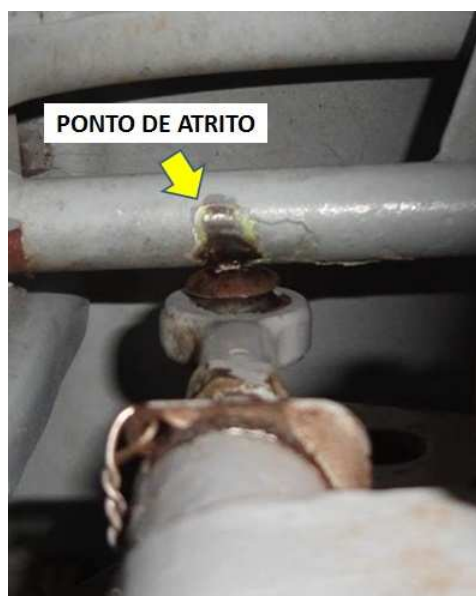
Figura 9 - Ponto de atrito que impediu o abaixamento do trem de pouso pelo sistema de emergência - por gravidade.
