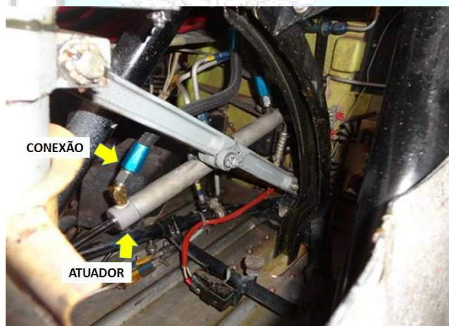
Figura 8 - Atuador do trem de pouso do nariz e conexão ("part number" 79847-02), instalados no EMB-810D.
