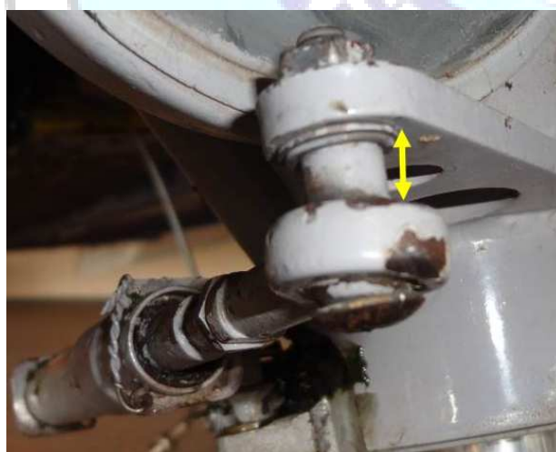
Figura 11 - Haste do amortecedor de vibração lateral instalada na aeronave PT-VLO. A seta amarela indica um espaçamento de 6,2mm.
