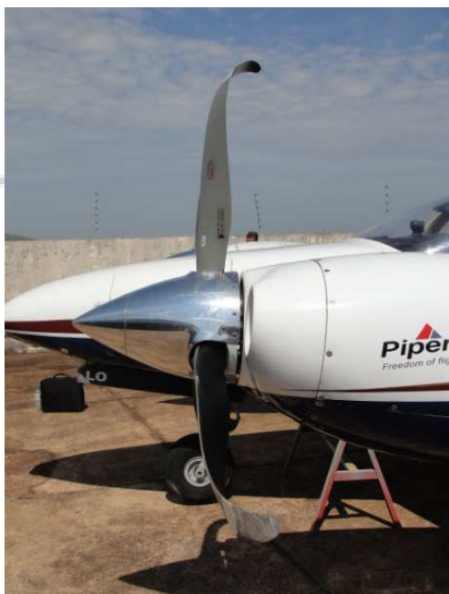
Figura 5 - Danos à hélice esquerda.
