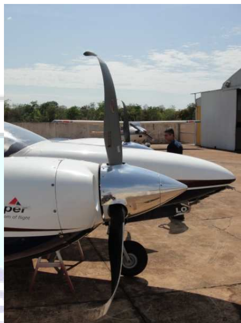
Figura 6 - Danos à hélice direita.
