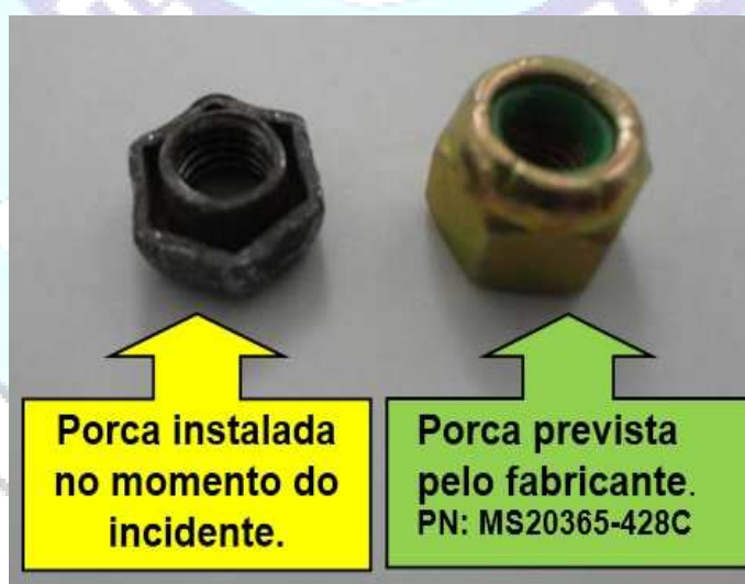
Figura 15 - Comparação entre a porca encontrada no PT-VLO e a prevista pelo fabricante.
