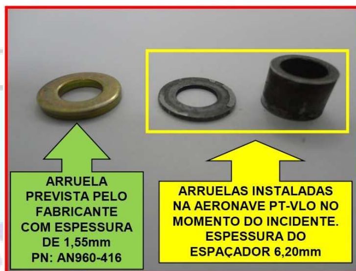
Figura 14 - Itens removidos do PT-VLO, comparados com os previstos pelo fabricante, constantes do catálogo de peças.
