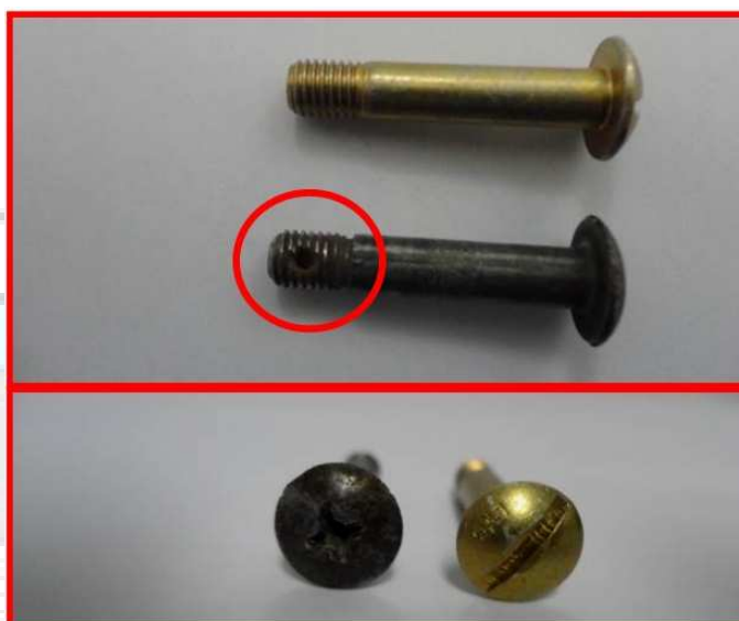
Figura 16 - O parafuso de coloração mais clara é o previsto pelo fabricante; o mais escuro foi o encontrado no PT-VLO.
