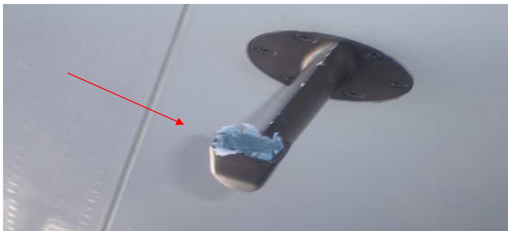
Figuras 2 - TAT sensor obstruído por plástico.
