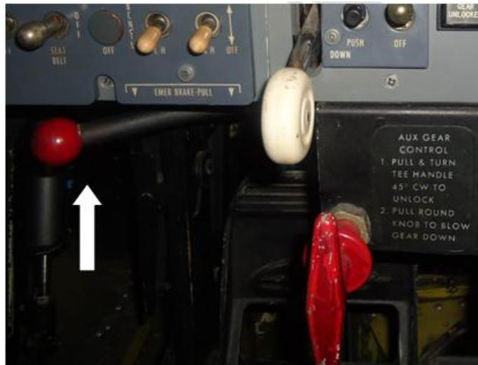
Figura 5 – Painel da aeronave *Citation I* com aplicação do boletim, onde se nota a alavanca mais visível.
