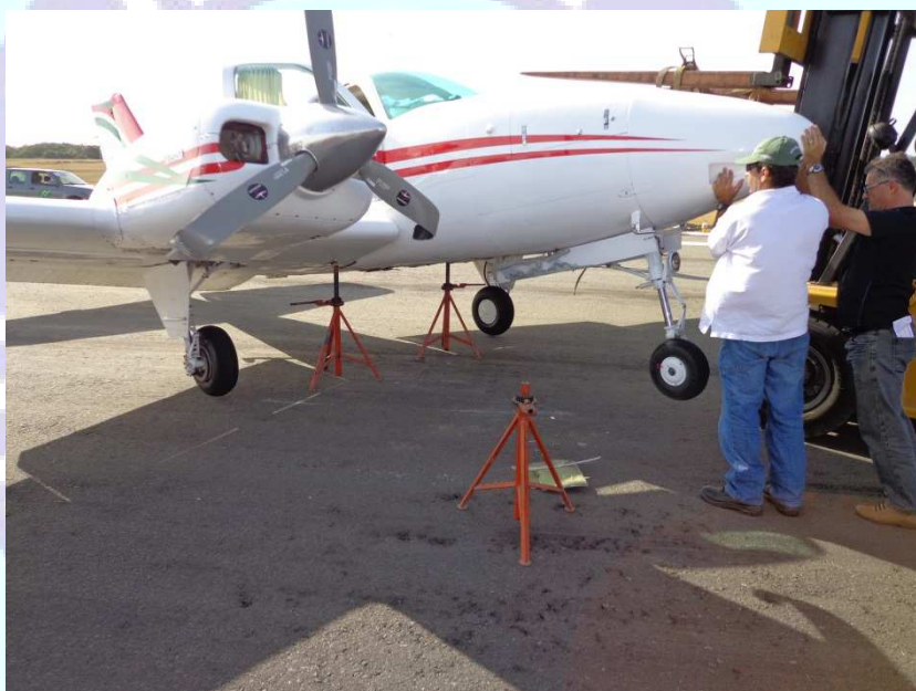
Figura 2 - Aeronave sobre os macacos, após o acionamento do trem de pouso durante a remoção da pista.
