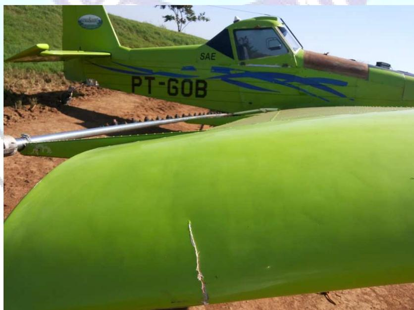
Figura 2 - Vista lateral da aeronave, com dano na ponta da asa.
