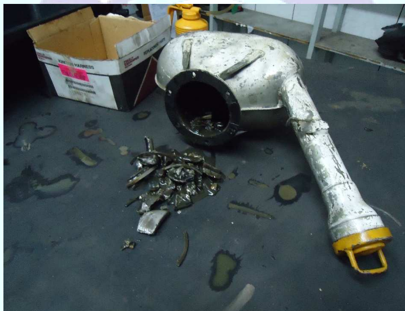
Figura 1 - Corpo da válvula de escapamento e pedaços do pistão encontrado dentro do cárter.
