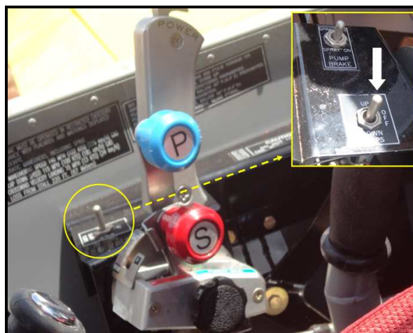
Figura 14 - Switch de comando dos flapes aprovado pelo fabricante, ao lado do pedestal de manetes.
