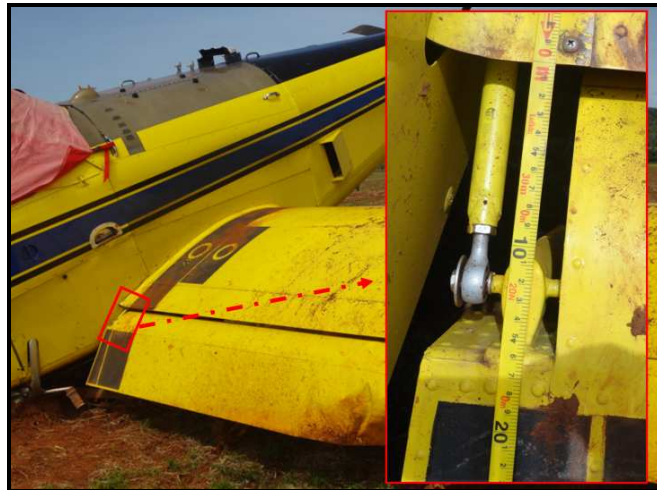
Figura 6 - Medição feita no painel de flape direito, indicando 17,7cm até os rebites da parte inferior.
