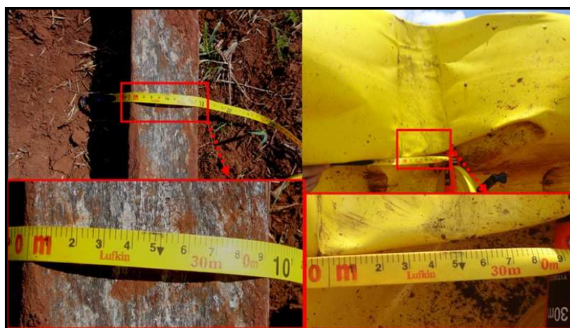
Figura 3 - À esquerda, o mourão da cerca com largura de 9 cm. À direita, a marca deixada pelo mesmo no bordo de ataque da asa esquerda (2º impacto).
