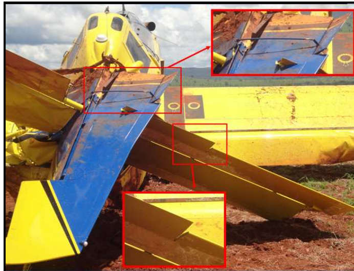
Figura 7 - Posição dos compensadores do leme e do profundor.
