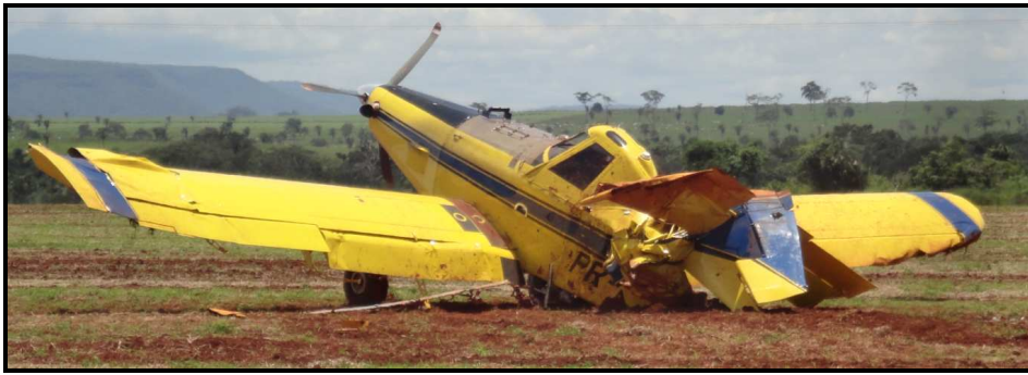
Figura 9 - Danos à seção traseira da aeronave.
