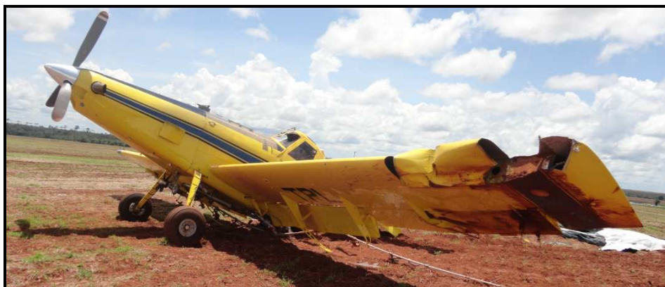
Figura 8 - Danos ao bordo de ataque da asa esquerda.
