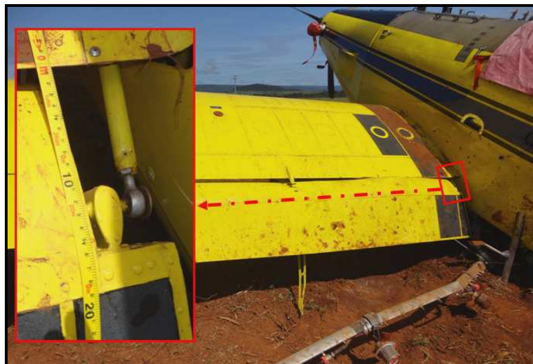
Figura 5 - Medição feita no painel de flape esquerdo, indicando 17,7cm até os rebites da parte inferior.
