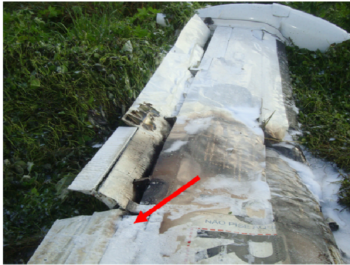
Figura 20 - Flape da asa esquerda na posição 18° no local de impacto, tal qual o da asa direita.
