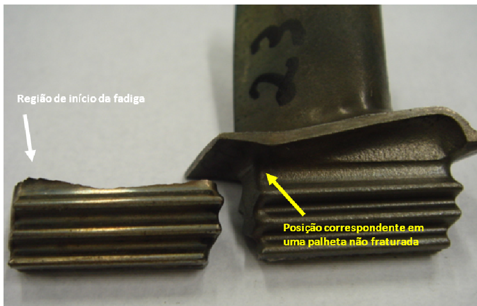
Figura 26 - Início da fadiga na palheta S/N T52A175 e posição correspondente numa palheta não danificada.
