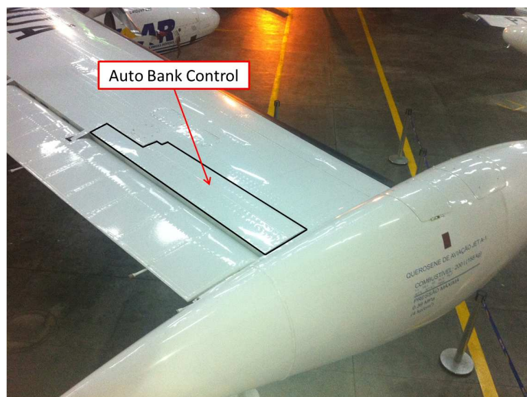
Figura 47 - Superfície fechada do auto bank control da asa direita.
