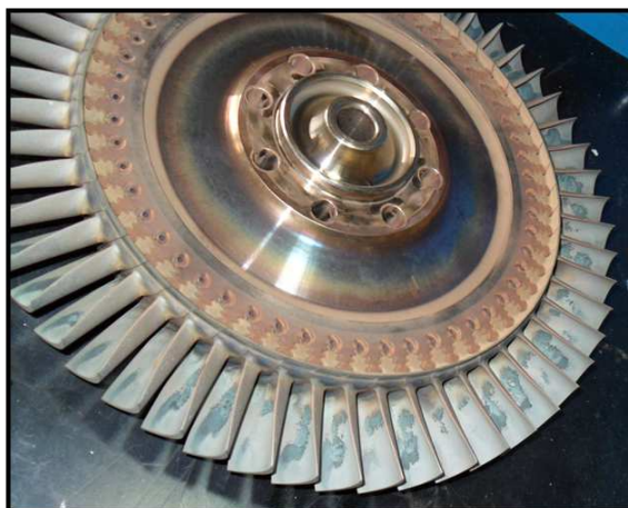
Figura 4 - Disco de turbina do compressor removido devido à corrosão a altas temperaturas.
