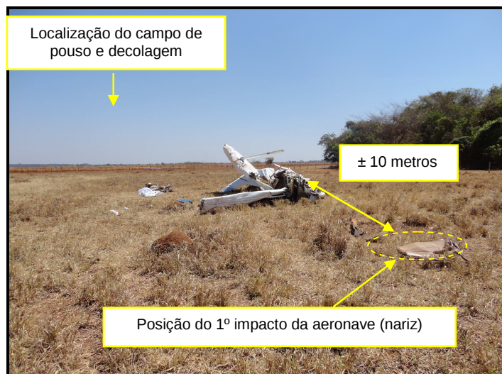
Figura 3 - Posicionamento da aeronave após o acidente.
