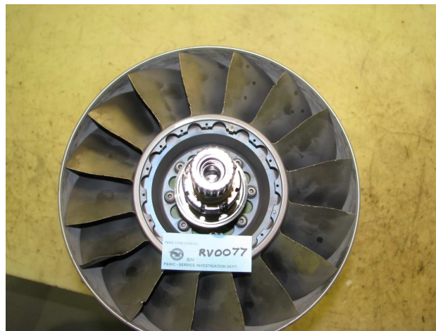
Figuras 4 e 5 - Vista aproximada da deformação e impacto nas demais pás.
