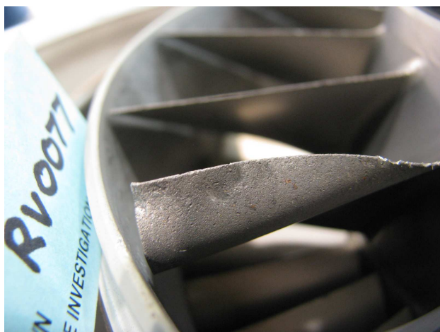
Figuras 4 e 5 - Vista aproximada da deformação e impacto nas demais pás.
