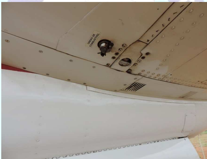
Figura 14 - Drenos de combustível da aeronave.
