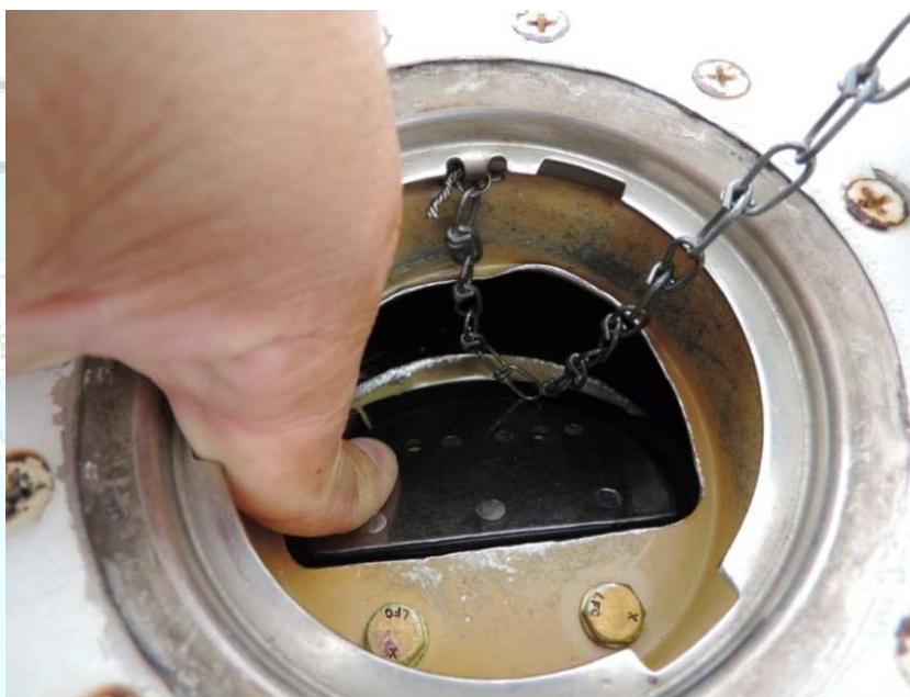
Figura 13 - Bocal de abastecimento da aeronave.
