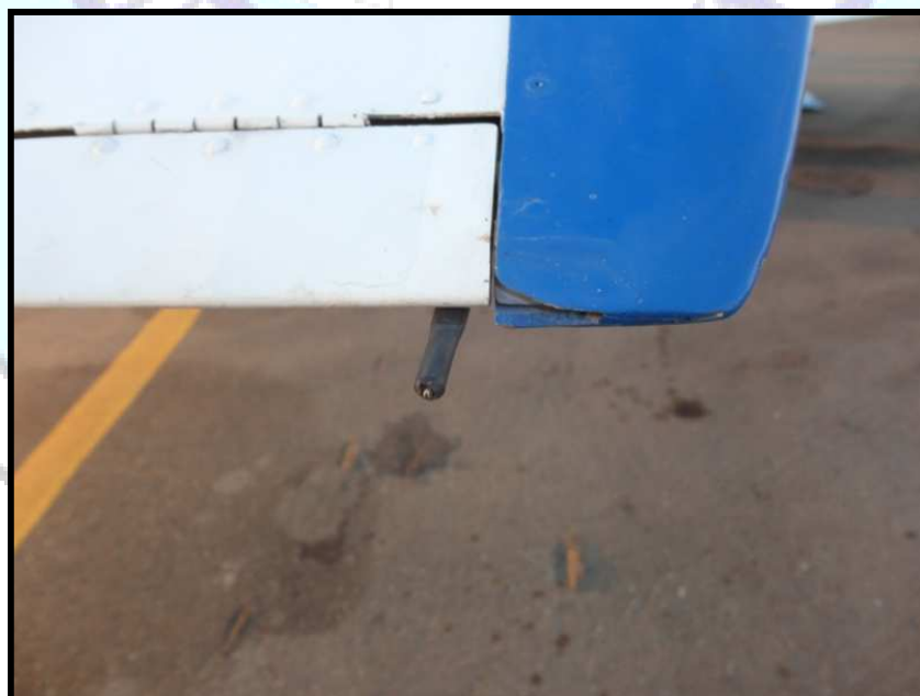
Figura 7 - Ausência dos descarregadores estáticos.
