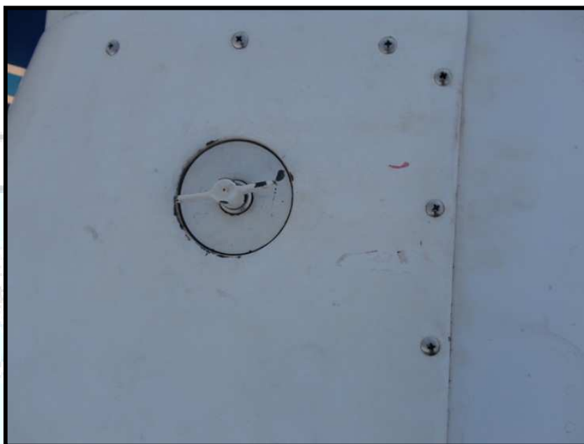
Figura 2 - Bocal de abastecimento sem indicação do tipo de combustível utilizado na aeronave.
