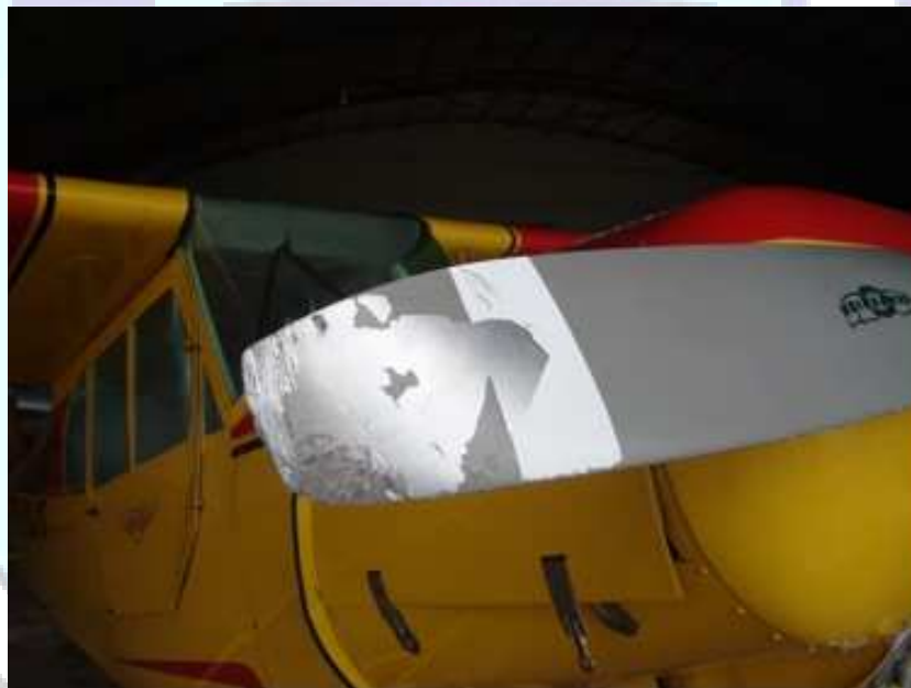
Figura 2 – Vista da pá da hélice danificada.
