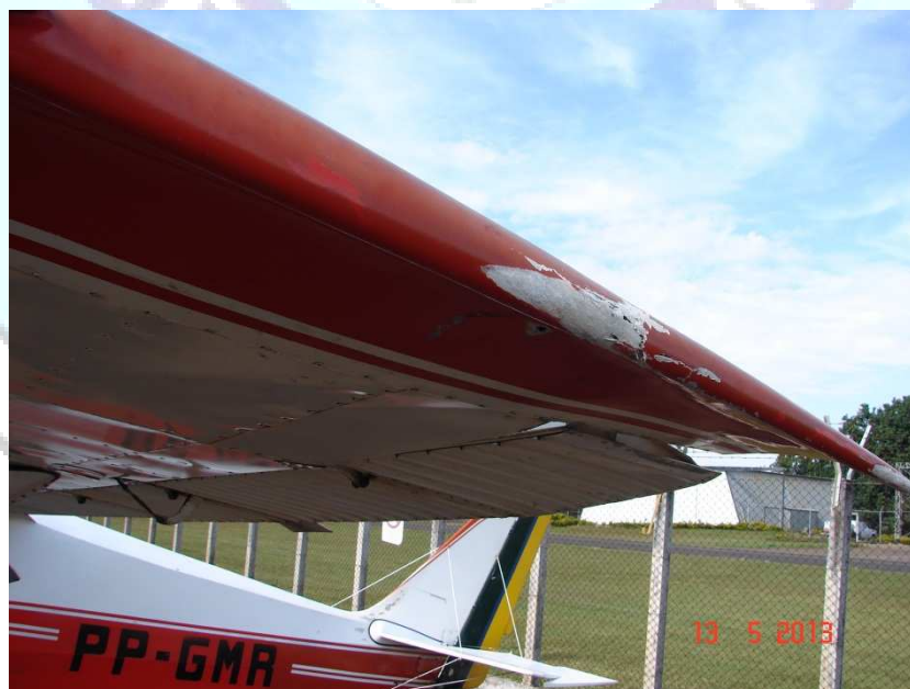
Figura 2 - Ponta da asa e aileron esquerdo danificados.
