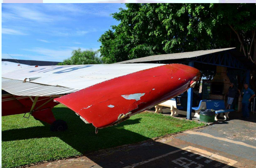
Figura 2 - Danos na ponta de asa direita.
