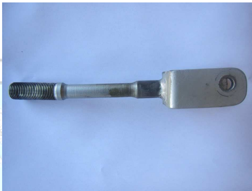
Figura 2 -Garfo de fixação do trem de pouso com deformação.
