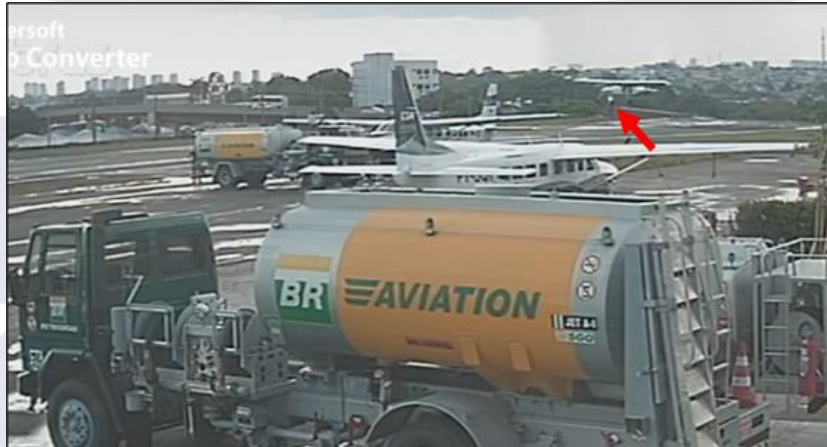
Figura 2 - Imagem da aeronave chegando para pouso momentos antes do acidente. No detalhe, observa-se que o conjunto do trem de pouso auxiliar está defasado, aproximadamente, 90° à esquerda.
