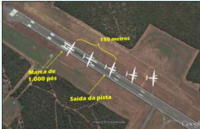
Figura 1 – Croqui do Aeroporto de Palmas (SBPJ) com os pontos de toque, de saída da pista e de parada total da aeronave.
