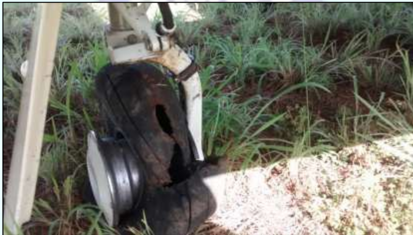
Figura 4 – Danos ao trem de pouso principal esquerdo.
