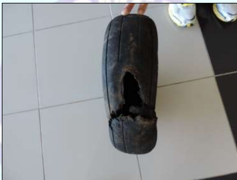
Figura 5 – Pneu da aeronave com marcas indicativas de travamento da roda.
