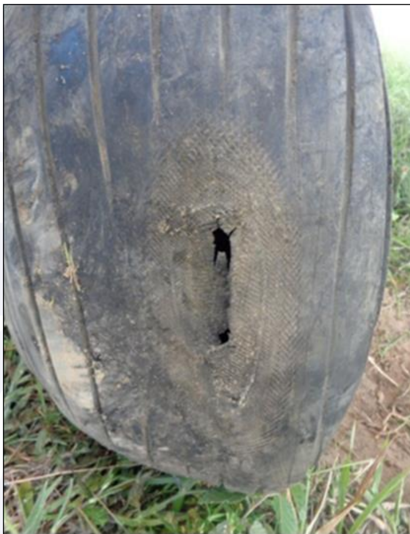
Figura 10 - Dano no pneu da roda do trem de pouso esquerdo.
