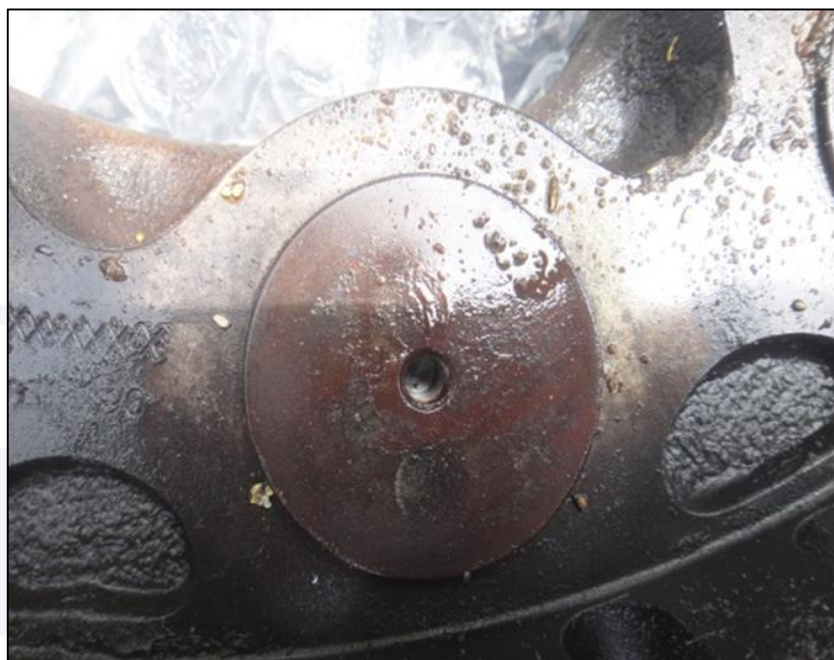
Figura 8 - Piston assembly com vazamento de fluido.
