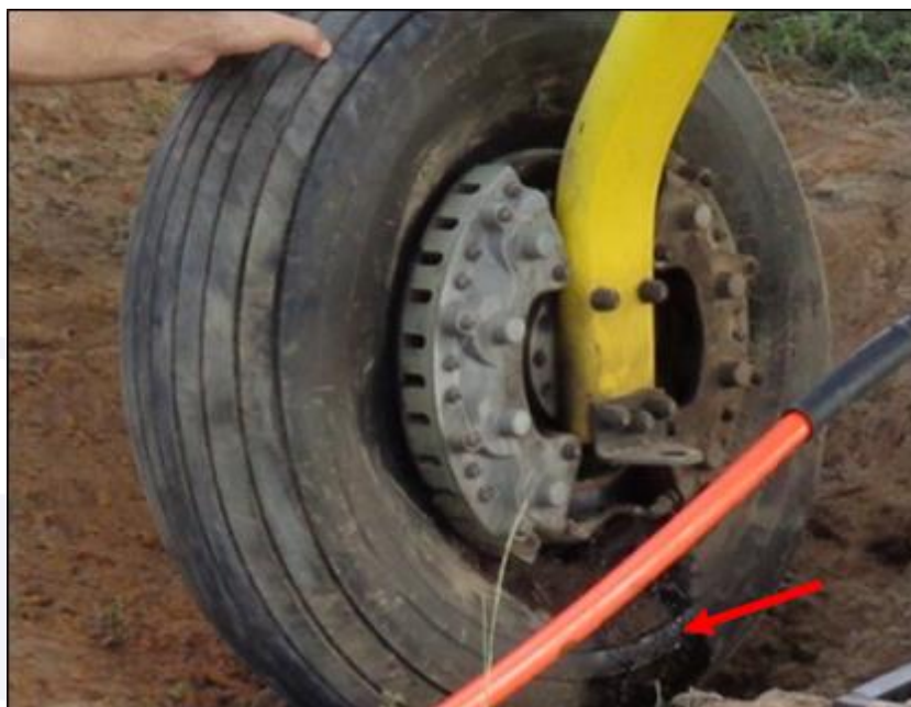
Figura 6 - Vazamento de fluido pelo conjunto de freio da roda de trem de pouso direito.
