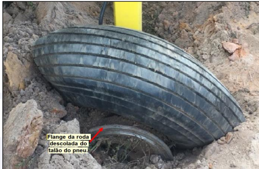
Figura 5 - Aspecto da roda do trem de pouso direito.
