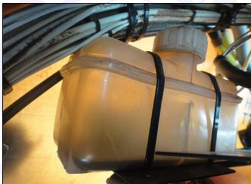
Figura 9 - Reservatório de fluido de freio vazio.
