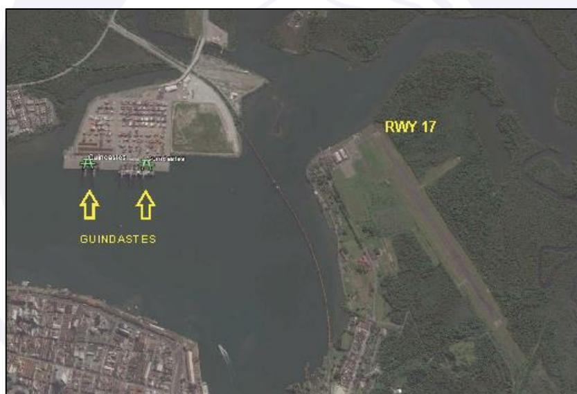
Figura 133 - Posição dos guindastes em relação à cabeceira 17 de SBST, conforme descrito em NOTAM.
