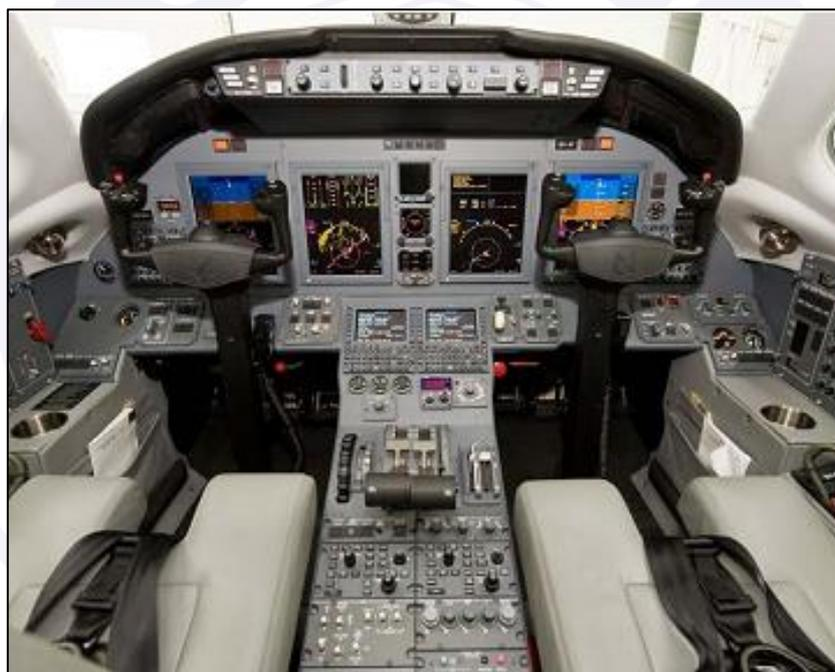
Figura 127 - Foto do painel do modelo CE 560XLS+ (aviônicos Collins Pro Line 21) similar ao operado no momento do acidente.
