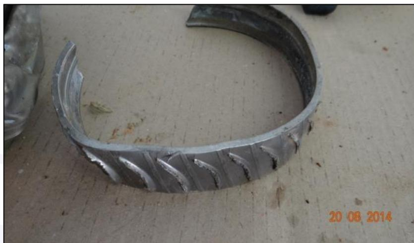
Figura 113 - Vista geral do anel interno do estator do segundo estágio do compressor de alta pressão.
