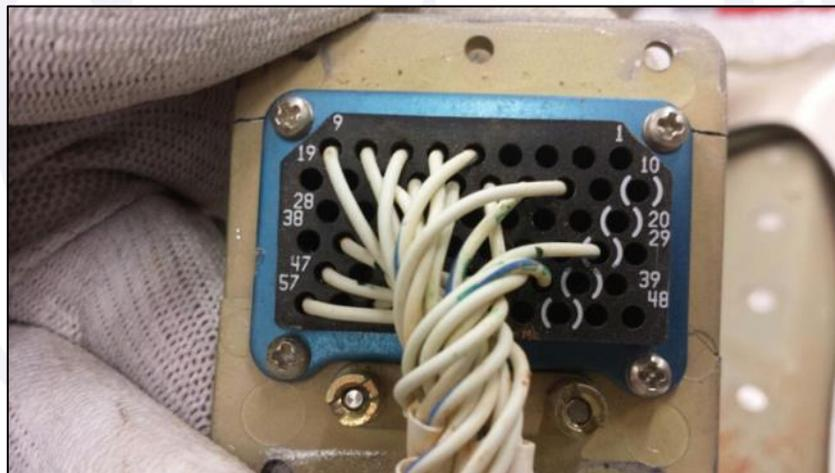
Figura 34 - Conector traseiro do FA2100CVR com respectivos fios e pinagem.
