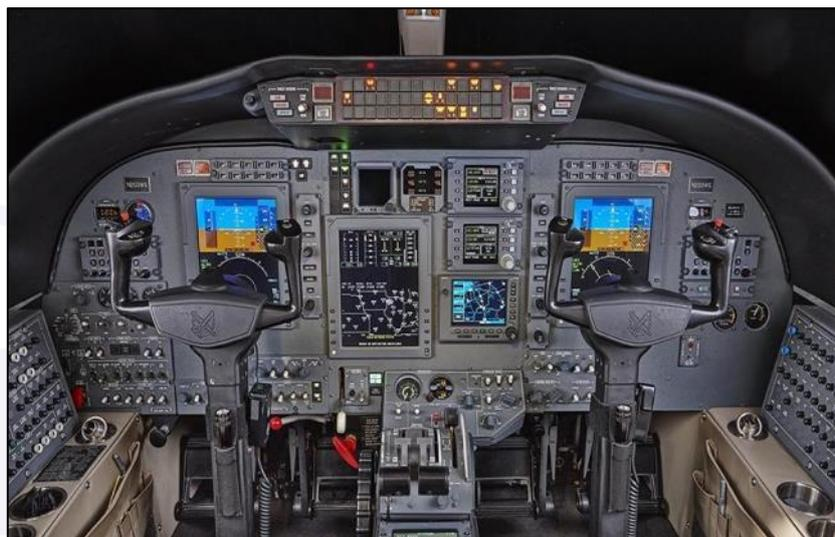
Figura 126 - Foto do painel do modelo C560 Encore+ (aviônicos Collins Pro Line 21) similar ao operado, anteriormente, pelo copiloto.
