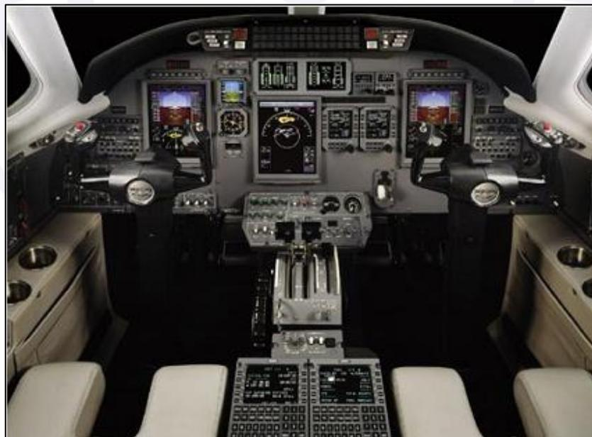
Figura 125 – Foto do painel do modelo CE 560XLS (aviônicos Honeywell Primus 1000) similar ao operado, anteriormente, pelo comandante.
