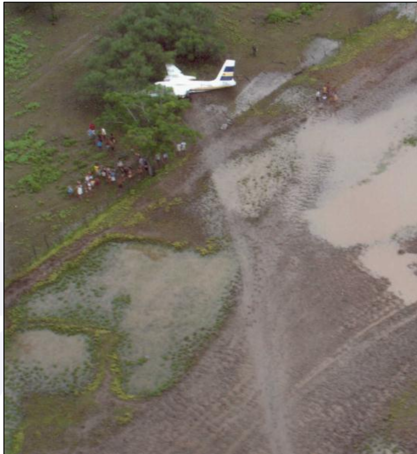
Figura 2 - Vista aérea das marcas deixadas no solo pela aeronave.
