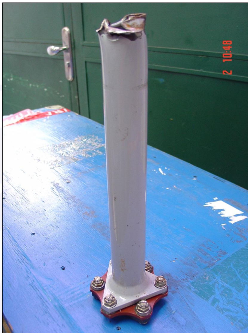
Figura 5 - Eixo de ligação do motor com a caixa principal apresenta rompimento próximo do ponto de fixação na caixa principal.
