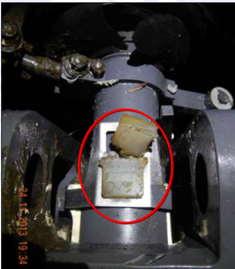
Figura 13 – Teeter stop da cabeça do rotor principal partido.
