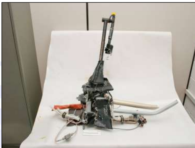
Figura 19 – Conjunto do comando cíclico, incluindo o mecanismo de ajuste de fricção, enviado ao DCTA.
