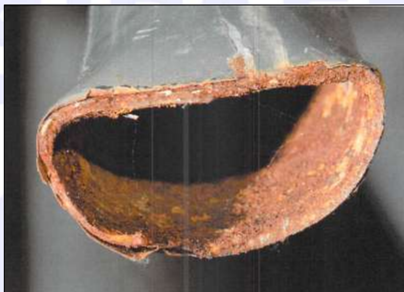
Figura 29 – Tubo da treliça fraturado por sobrecarga, com deformações do tipo “boca de peixe” nas rupturas dos tubos.
