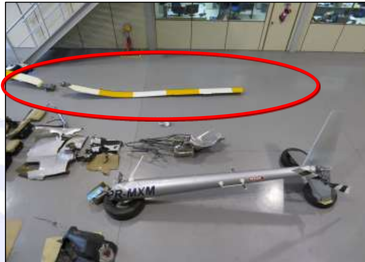
Figura 9 – Pá do rotor principal com deflexão para cima.
