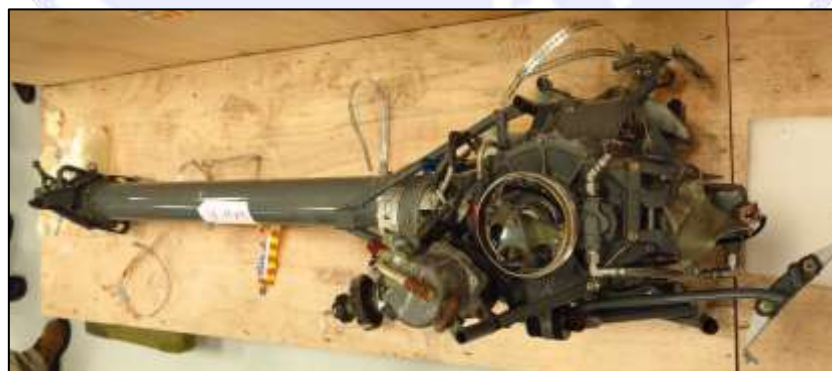
Figura 30 – Transmissão principal da aeronave que foi analisada na sede do fabricante.
