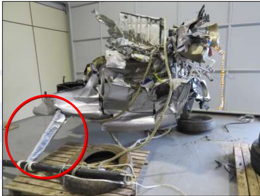
Figura 14 – Forward strut fairing com deformações.
