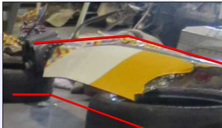
Figura 10 – Pá do rotor principal com deflexão para baixo.
