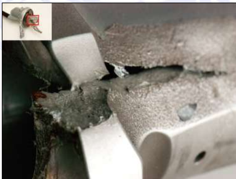
Figura 21 – Superfície de fratura do spindle da pá.
