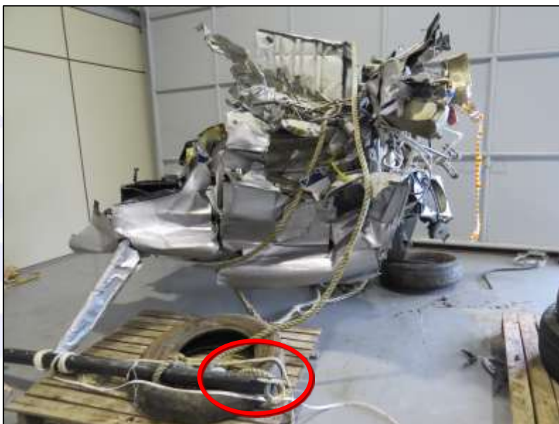
Figura 12 – Esqui esquerdo com quebra na parte traseira.
