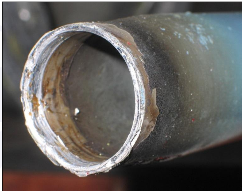
Figura 15 - Extremidade do eixo longo rompida na região de conexão com o eixo curto.
