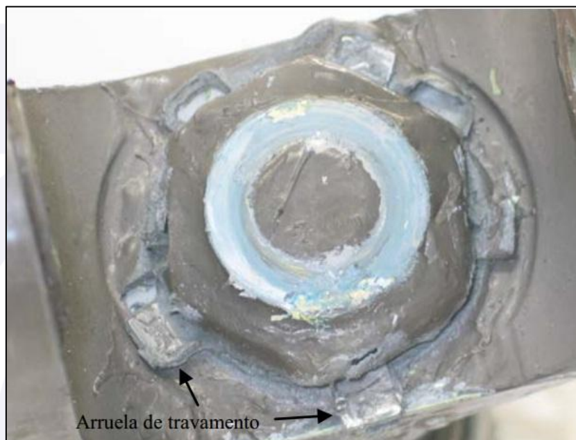
Figura 7 – Parafuso de fixação do garfo ao eixo cônico. Nota-se que a arruela de travamento está fora de sua posição original e que há uma marca circular azul em torno da cabeça do parafuso.
