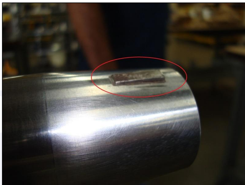
Figura 5 - Eixo cônico pronto para ser instalado. Detalhe para a chave na parte superior do eixo.
