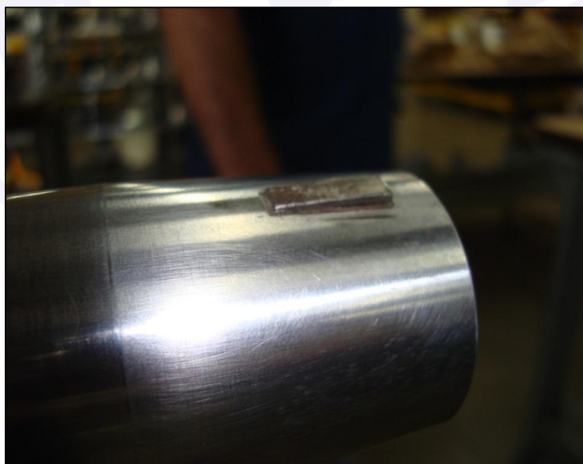
Figura 28 - Chaveta instalada antes da aplicação do torque simulando giro.
