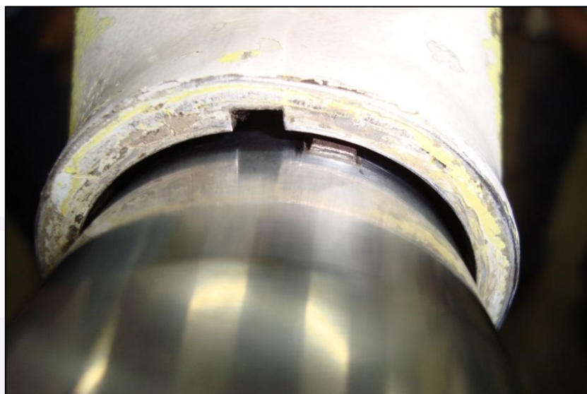
Figura 23 - Montagem incorreta do garfo no eixo cônico.
