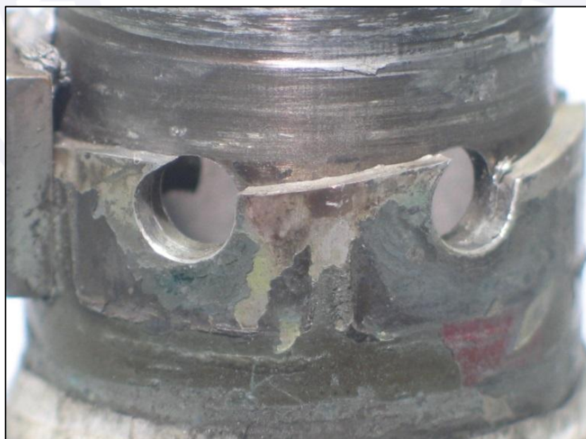
Figura 14 - Falha observada no eixo longo. Inclinação da fratura indica que houve sobrecarga por torção
