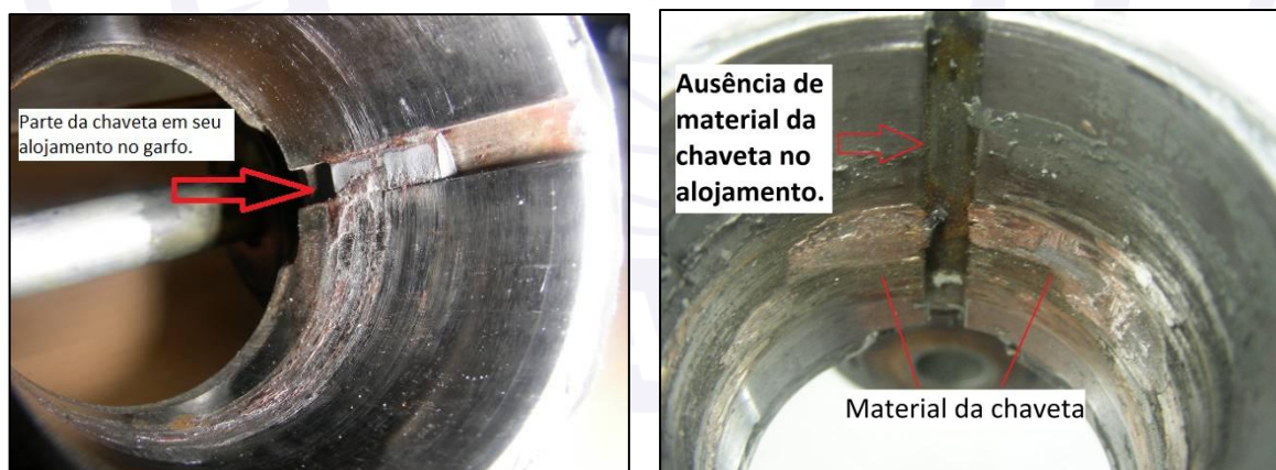
Figura 10 – Comparação entre um garfo com fratura da chaveta (esq.) e o garfo do PT-YRE (dir.).
