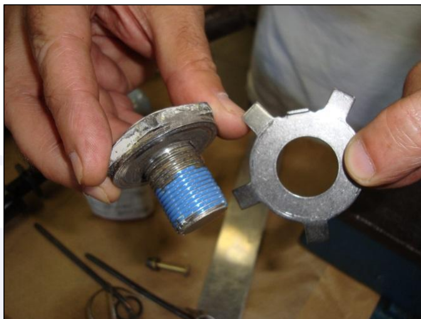
Figura 22 - Aplicação do Loctite no parafuso, antes da aplicação do torque final.
