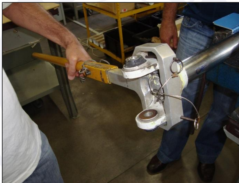
Figura 21 - Aplicação de torque no parafuso com o uso de um torquímetro.
