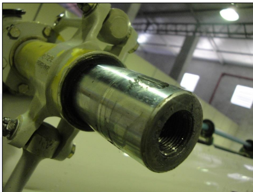
Figura 29 – Chaveta com perda de material, após aplicação de torque simulando giro.
