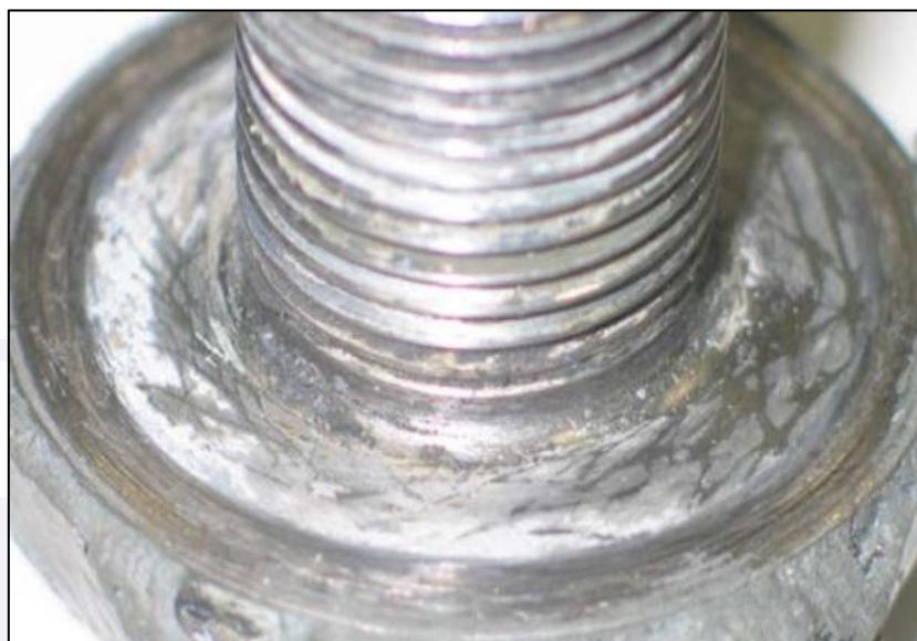
Figura 9 – Marca de atrito circular na parte de baixo da cabeça do parafuso de fixação do garfo ao eixo cônico.
