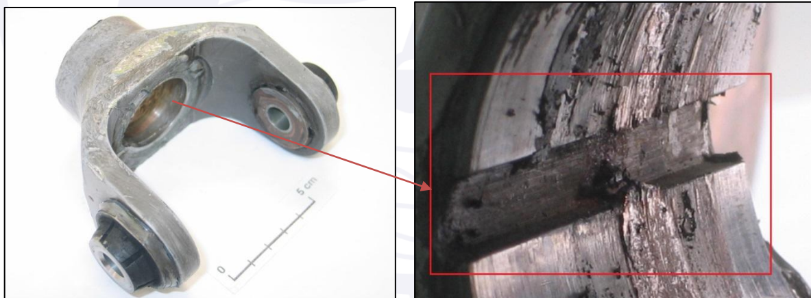
Figura 6 – Garfo de sustentação das pás do PT-YRE (esq.). No detalhe, a parte interna do garfo com o alojamento da chave em destaque.
