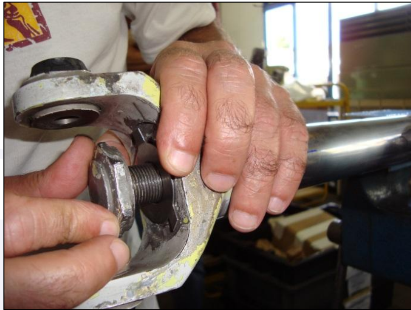
Figura 20 - Instalação do parafuso
