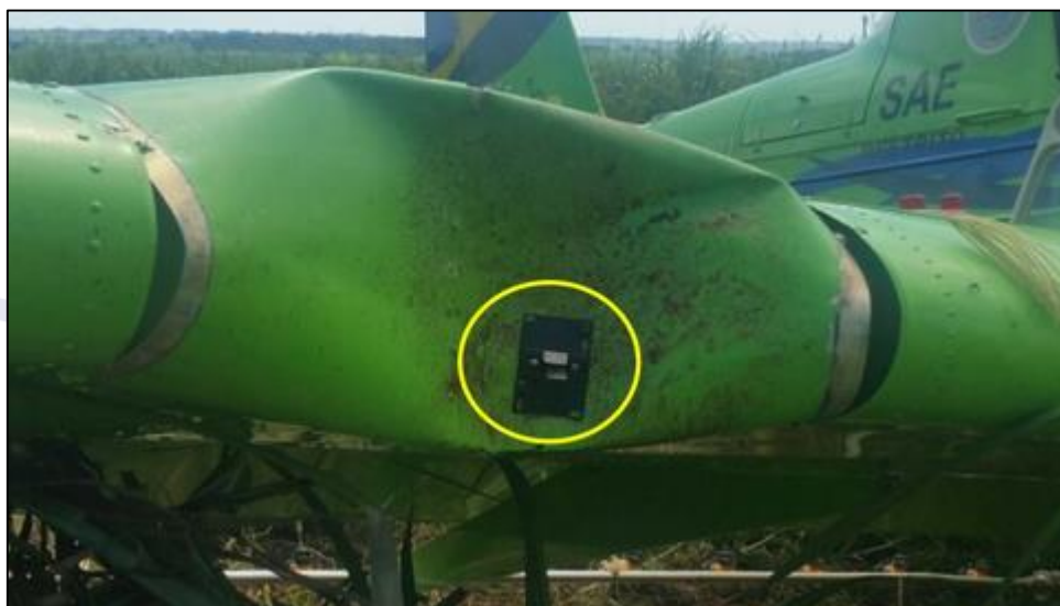
Figura 2 - Danos ao bordo de ataque da asa direita, com destaque para o detector de estol.
