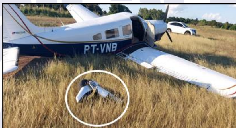
Figura 2 - Posição do trem principal direito após o acidente.
