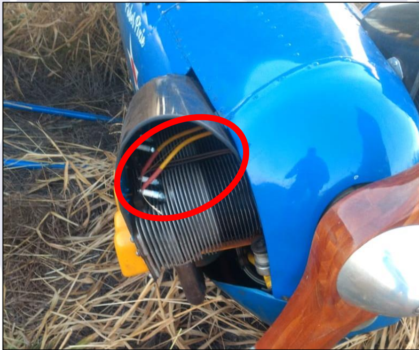
Figura 2 - Vista das velas e cablagem do motor.
