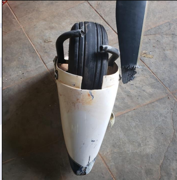
Figura 3 - Situação do trem de pouso auxiliar danificado.
