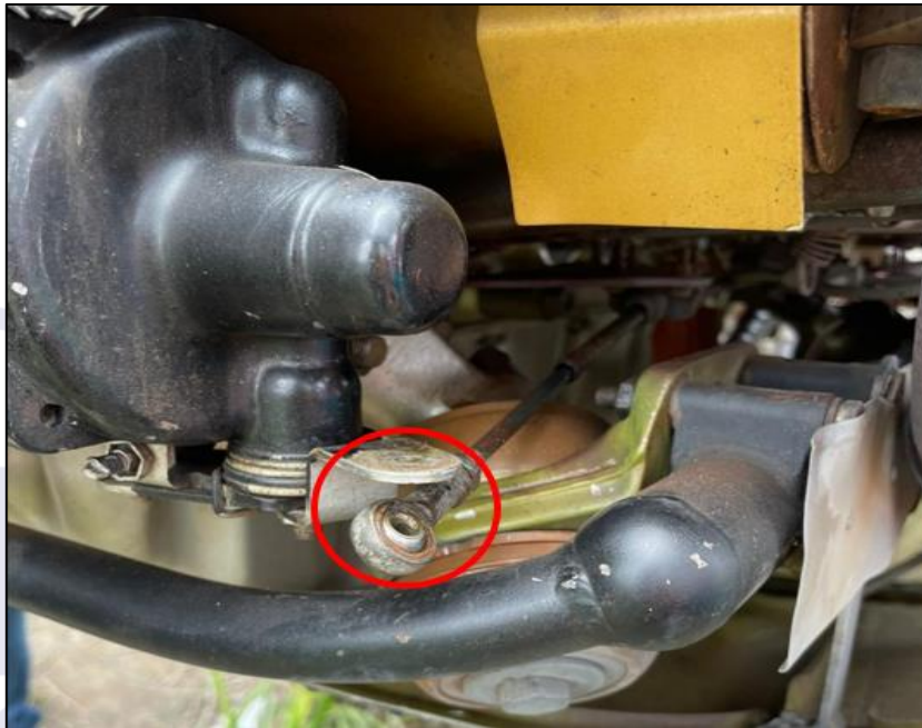
Figura 3 - Foto da haste do governador de hélice desconectada.
