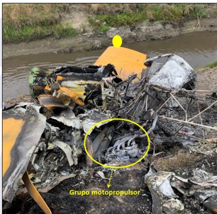
Figura 3 - Imagem da aeronave no local do acidente. No destaque, a posição em que foi encontrado o grupo motopropulsor.
