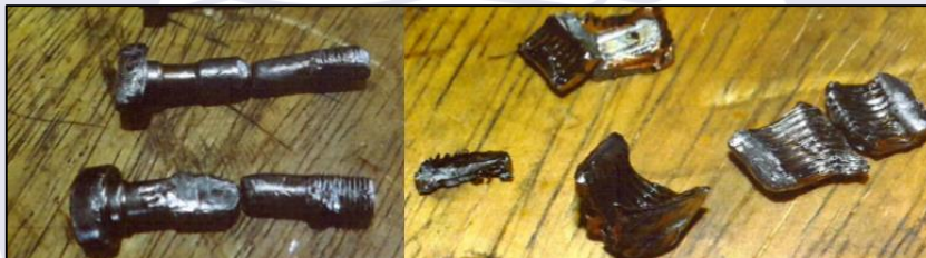
Figura 7 - Parafusos e de fragmentos das porcas da capa da biela do cilindro #6.
