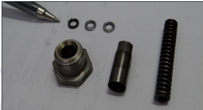
Figura 5 - Foto aproximada dos componentes que estavam instalados na válvula de alívio. A caneta indica as arruelas de pressão que foram encontradas.
