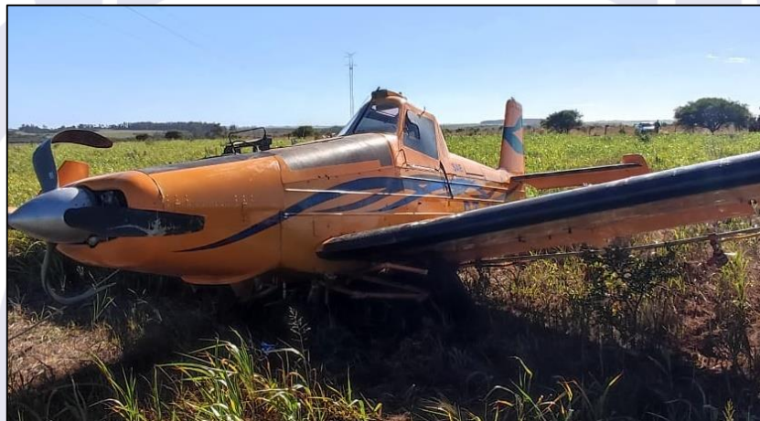
Figura 5 - Danos no trem de pouso e nas hélices após a colisão contra o solo.
