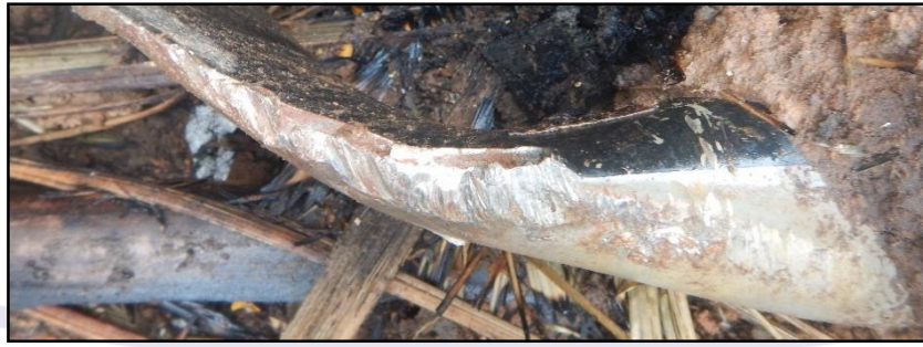
Figura 3 - Marca de possível toque do arame na raiz de uma das pás.
