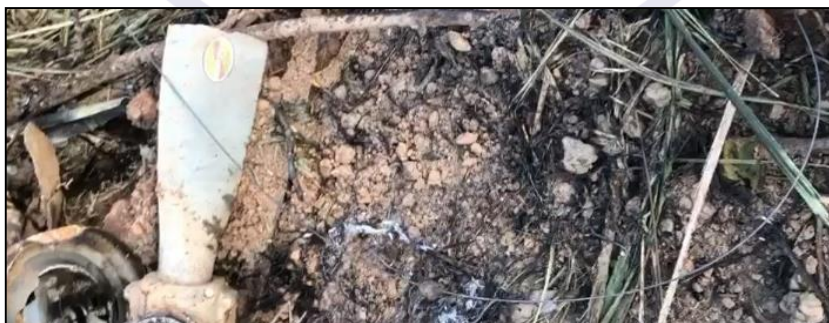
Figura 2 - Cabo de arame sobre pá da hélice, após a ocorrência.
