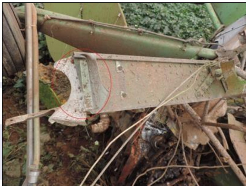
Figura 3 - Trecho da longarina da asa direita que apresentava sinais de fratura.
