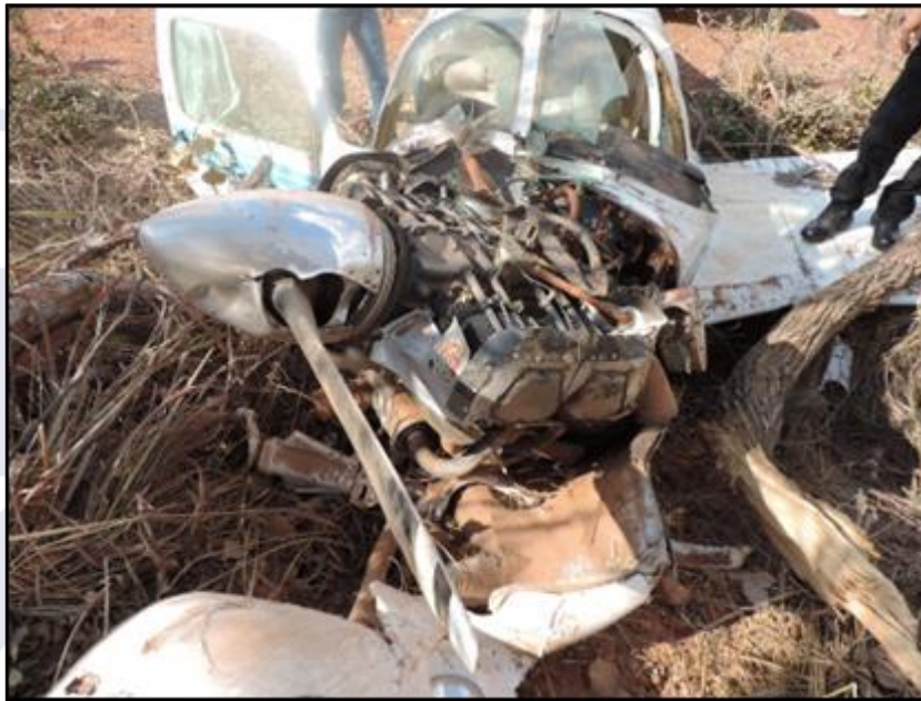
Figura 4 - Motor e hélices com danos compatíveis com uma colisão sem potência.
