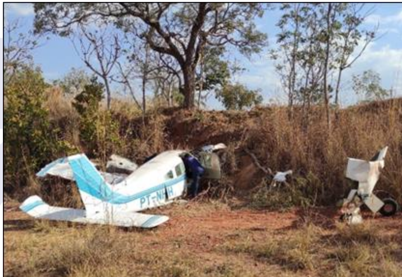
Figura 1 - Vista geral dos destroços sem indícios de fogo.
