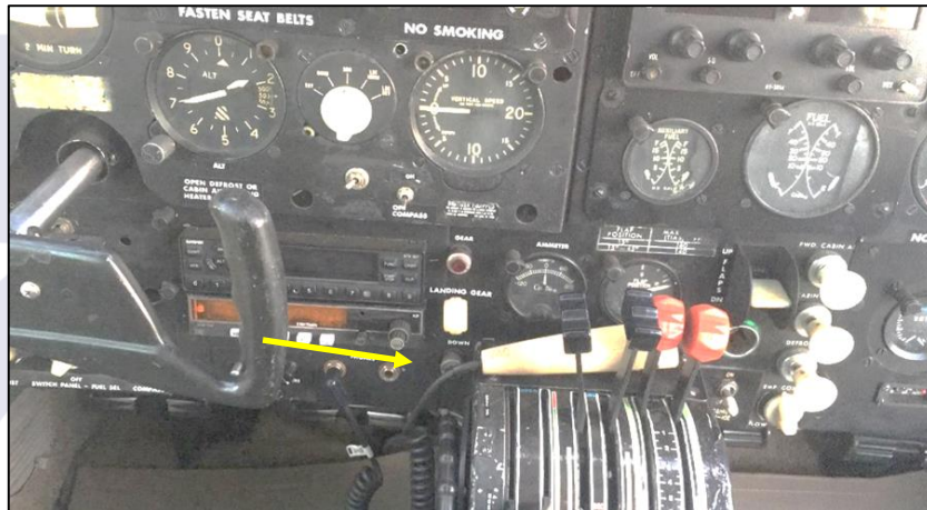
Figura 2 - Aspecto da visada do piloto em relação à luz âmbar de trem de pouso em trânsito.
