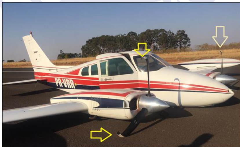
Figura 3 - Deformação para trás das pás das hélices após a parada final.
