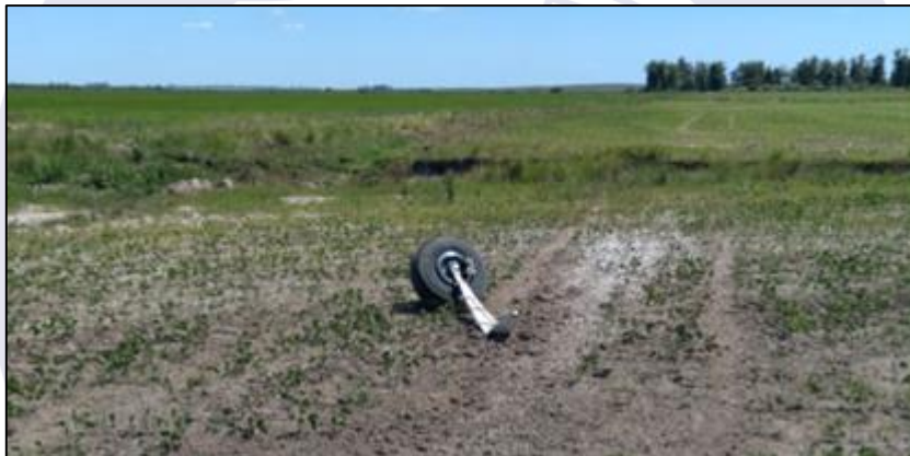
Figura 3 - Imagem do trem de pouso principal direito desprendido, a poucos metros local do primeiro impacto.
