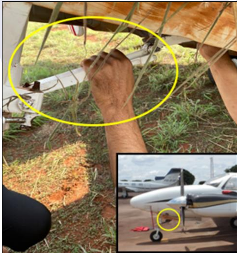
Figura 2 - Vista da haste de recolhimento do trem de pouso auxiliar do PR-MEJ.
