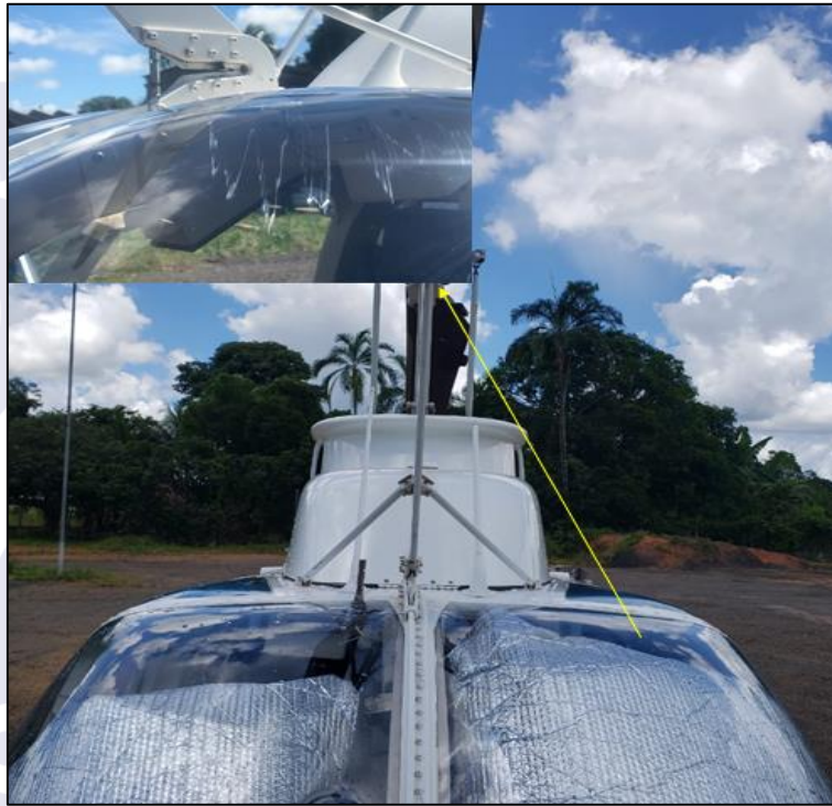
Figura 1 - Vista frontal do PR-HIB, com destaque para os danos no para-brisas.
