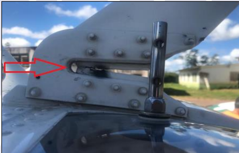
Figura 3 - Danos provocados ao corta-fios.
