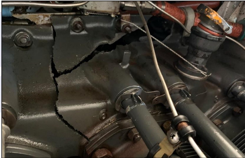
Figura 6 - Ruptura do bloco do motor entre os cilindros 5 e 6.
