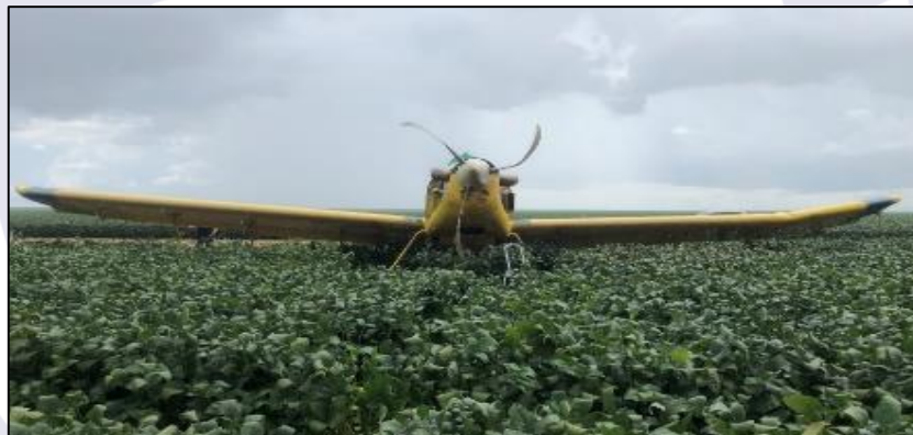
Figura 3 - Vista do conjunto de hélice e da asa esquerda avariados.
