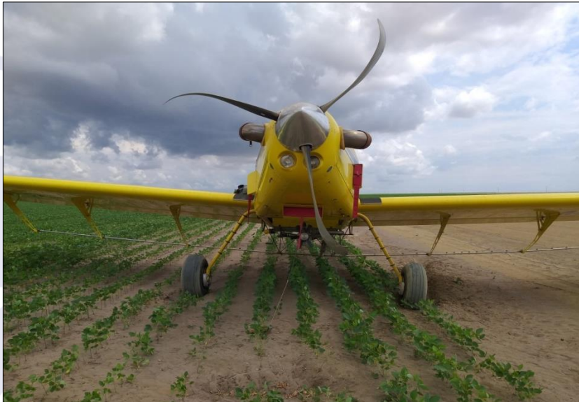
Figura 3 - Conjunto de hélice avariado.
