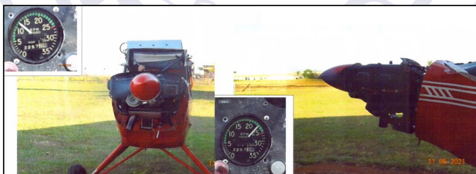
Figura 4 - Registro do teste funcional do motor a 1.200 e 2.400 RPM.
