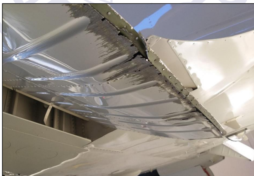
Figura 3 - Danos no flape da asa esquerda.
