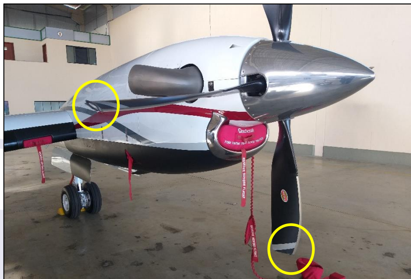
Figura 1 - Danos nas pás da hélice do motor esquerdo.
