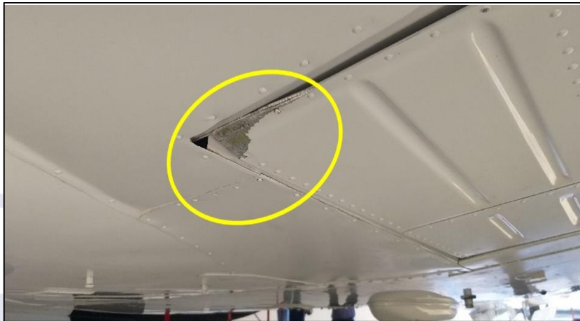
Figura 4 - Danos no flape da asa direita.
