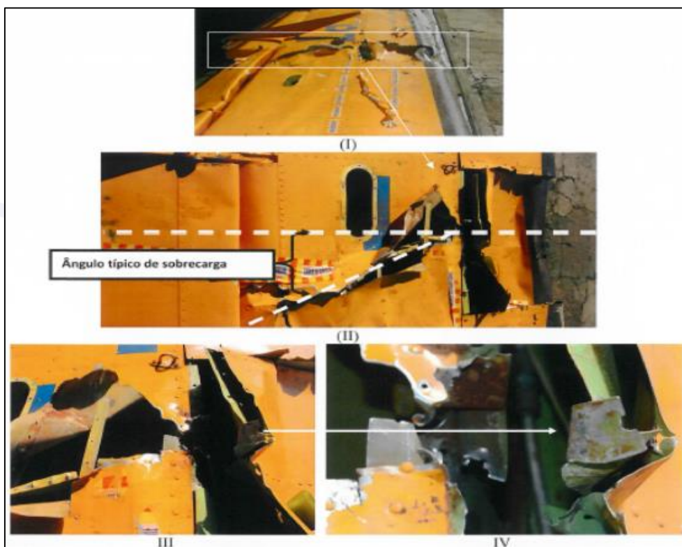
Figura 8 - Detalhes da fratura em ângulo da asa.
