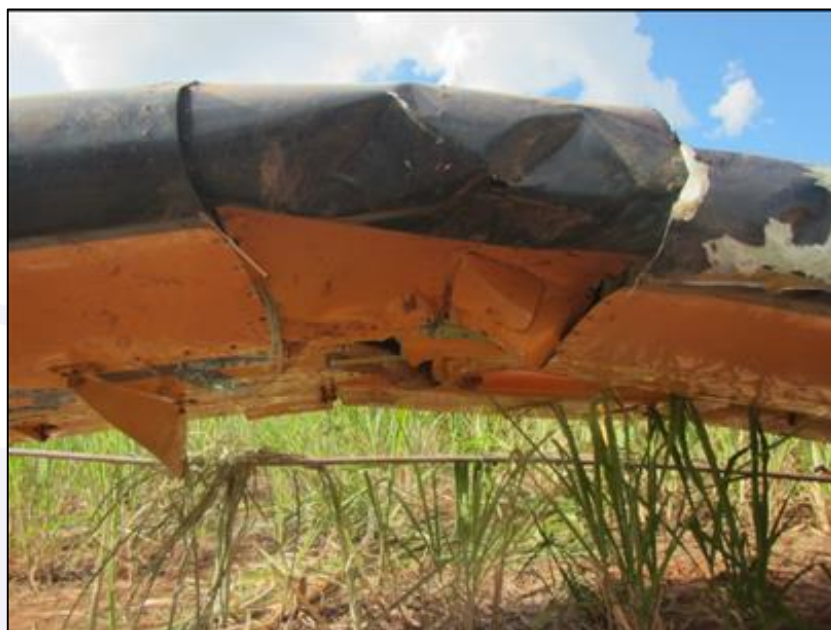
Figura 5 - Marcas de impacto na região do bordo de ataque da asa direita.
