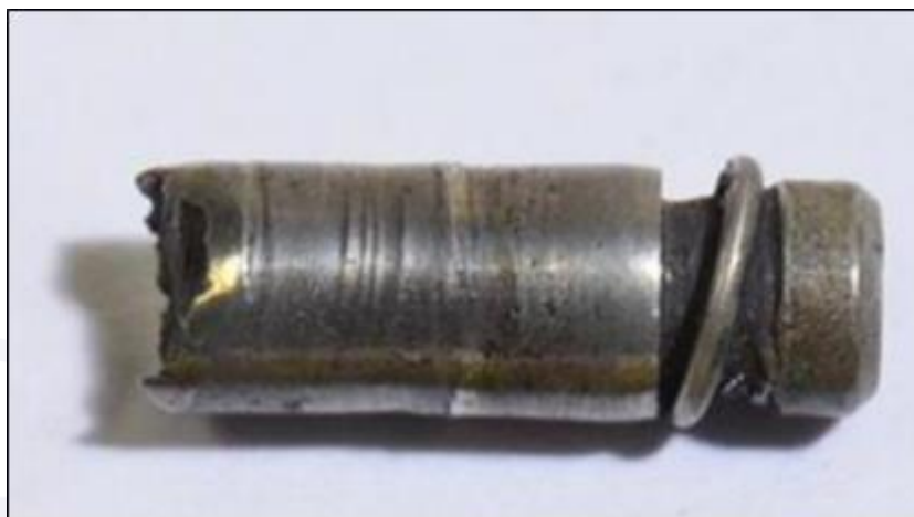
Figura 14 - Imagem do pino Quick Click PN 757497 fraturado.
