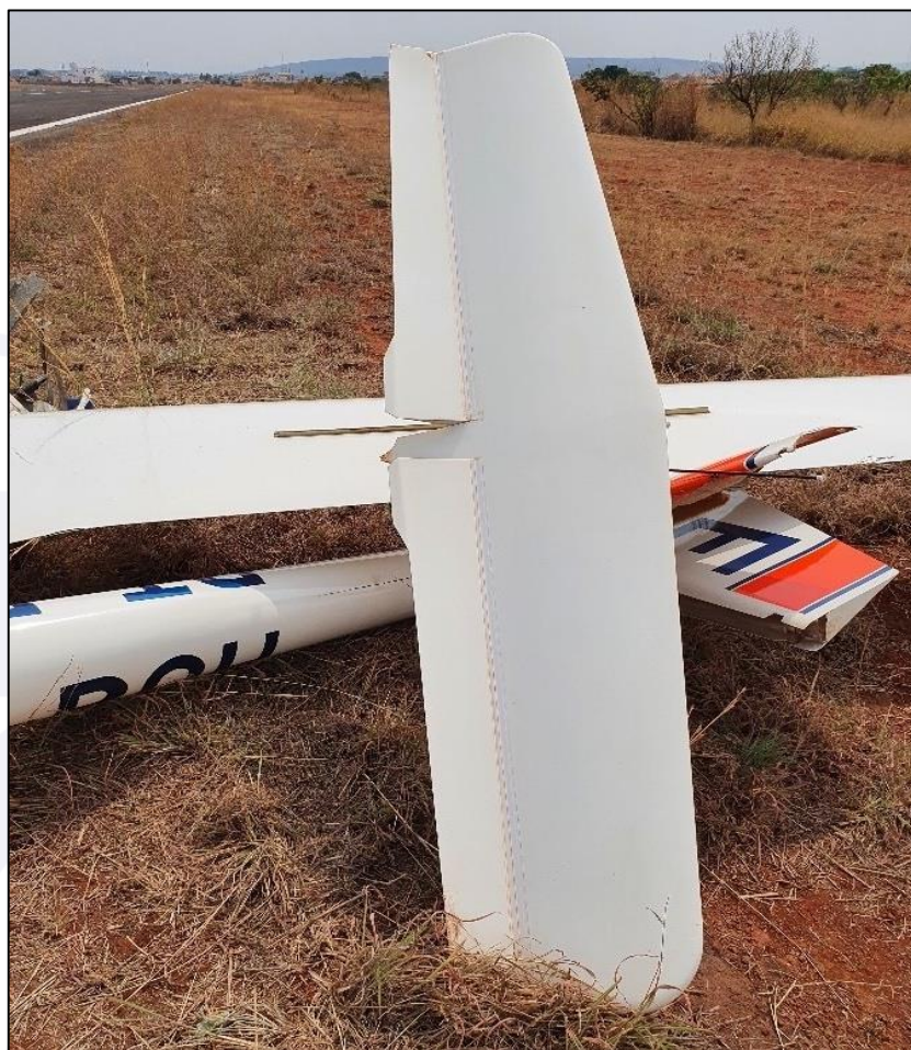
Figura 10 - Posição do profundor da aeronave.
