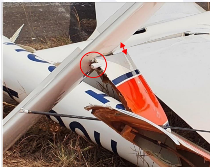
Figura 12 - Pino de fixação e deslocamento entre as partes posteriores dos estabilizadores horizontal e vertical.
