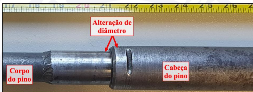
Figura 19 - Alteração de diâmetro cabeça/corpo do pino (escala em milímetros).
