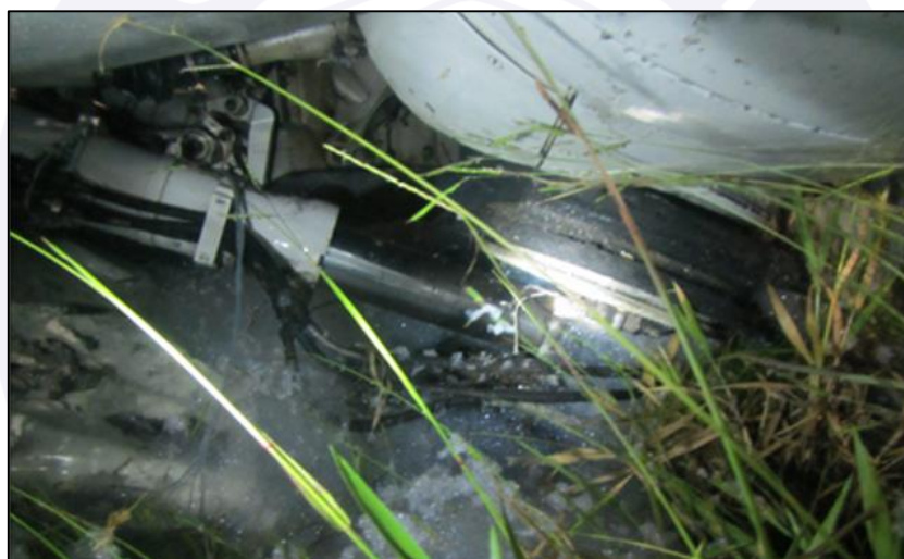
Figura 3 - Danos ao conjunto do sistema de trem de pouso esquerdo.
