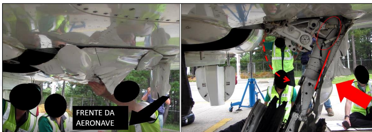
Figura 26 - Posição da comporta externa (no que seria a condição de trem recolhido) e curso máximo de extensão, tanto da perna do trem quanto da pestana, após o comando de extensão do TDPE.
