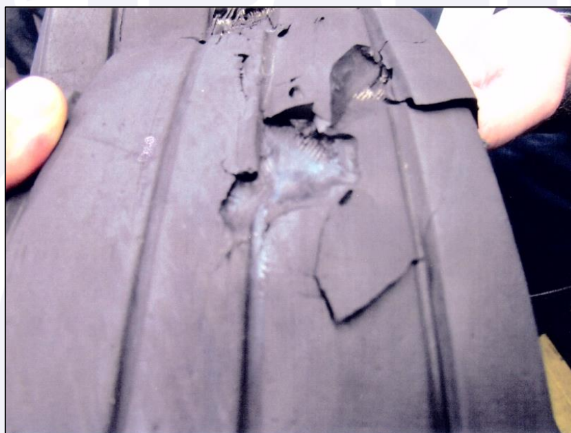
Figura 20 - Detalhe da região com cortes e perfurações com a trama abaixo da banda de rodagem exposta (pneu #1).
