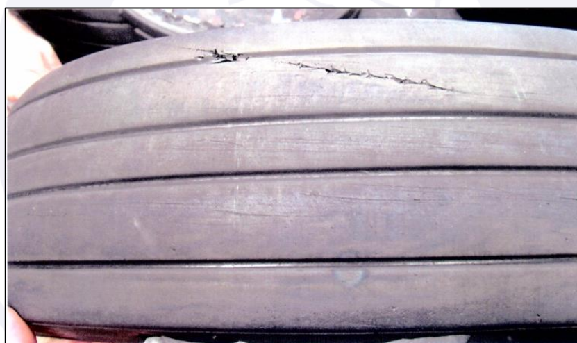
Figura 23 - Dano por corte e perfuração no pneu #2 com a banda não rompida.
