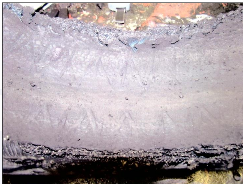
Figura 24 - Parte interna da banda de rodagem, sem danos e com superaquecimento na região do ombro do pneu #2.
