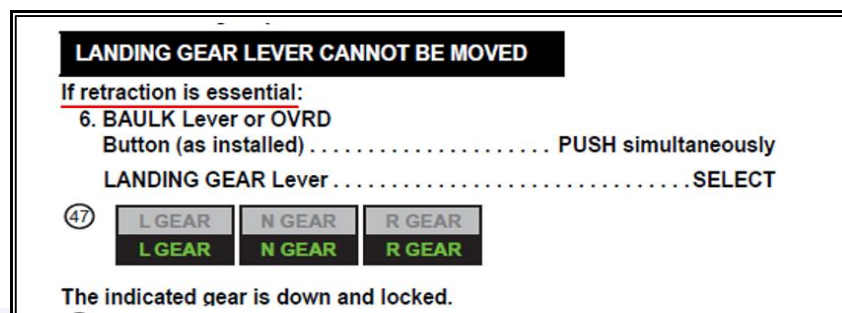
Figura 29 - Procedimento descrito no QRH para alavanca de comando do TDP travada na posição Gear Down após a decolagem ( Abnormal Situation "Landing Gear Lever Cannot be Moved" ).
