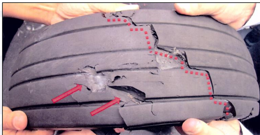
Figura 22 - Região perfurada por objeto externo e zona de rompimento da banda de rodagem do pneu #1.
