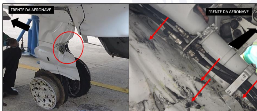
Figura 16 - Danos de impacto na comporta do TDPE (vista externa da faring ) e de transferência de material do tipo borracha (vista interna da faring ).
