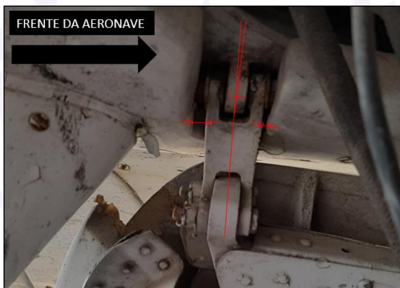
Figura 18 - Região da conexão da fairing com o intradorso da asa (vista interna).
