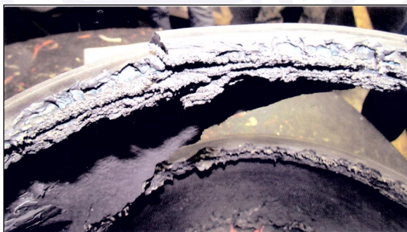
Figura 21 - Detalhe do ombro do pneu #1 com indícios de superaquecimento.
