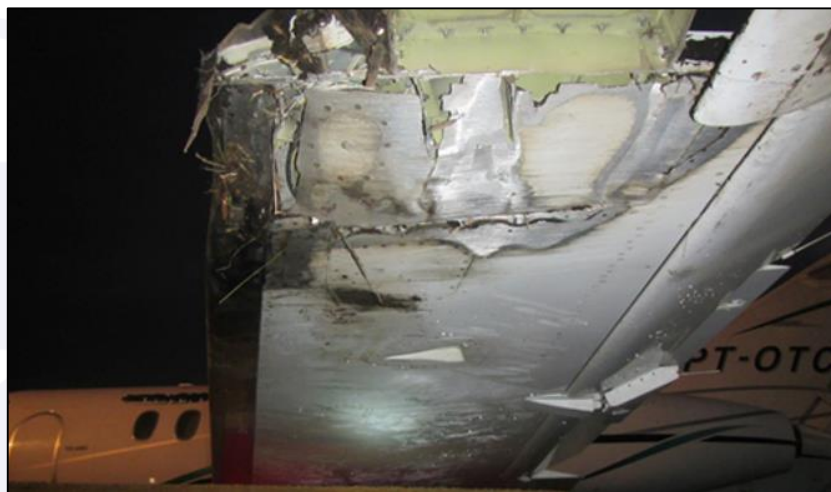
Figura 2 - Bordo de ataque e danos na ponta da asa esquerda.
