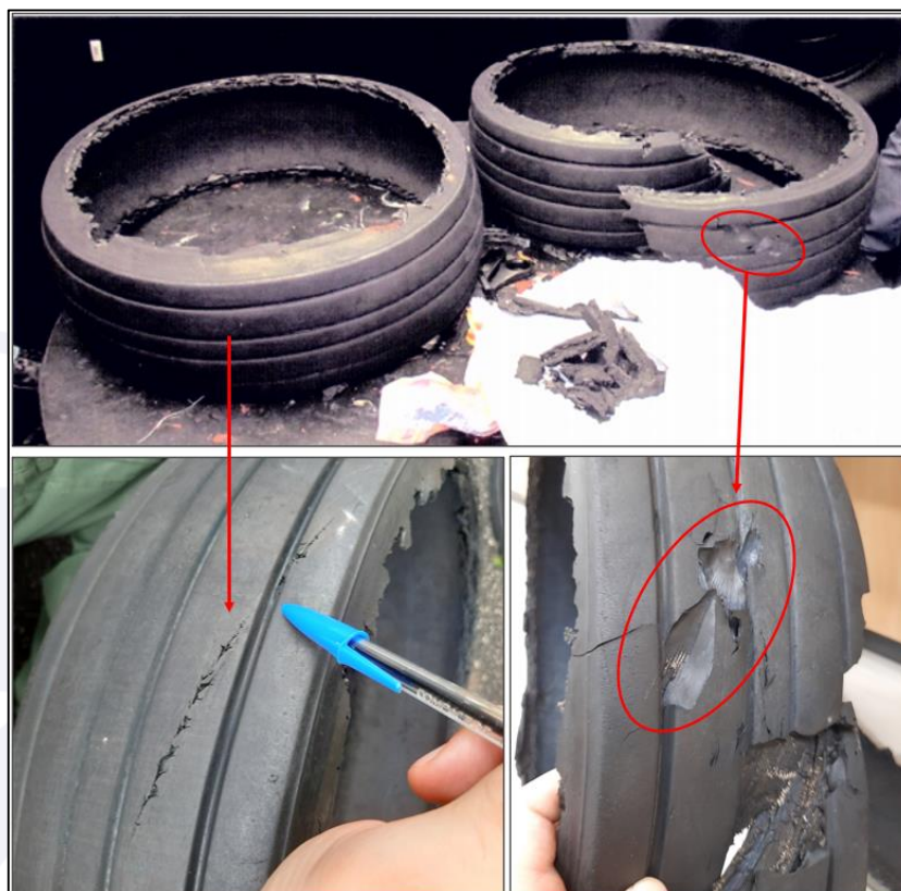
Figura 15 - Imagem da banda de rodagem do pneu #2 do lado esquerdo da foto e banda de rodagem do pneu #1 do lado direito.
