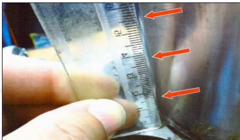
Figura 34 - Deformação observada na base do cilindro da hélice do motor esquerdo.
