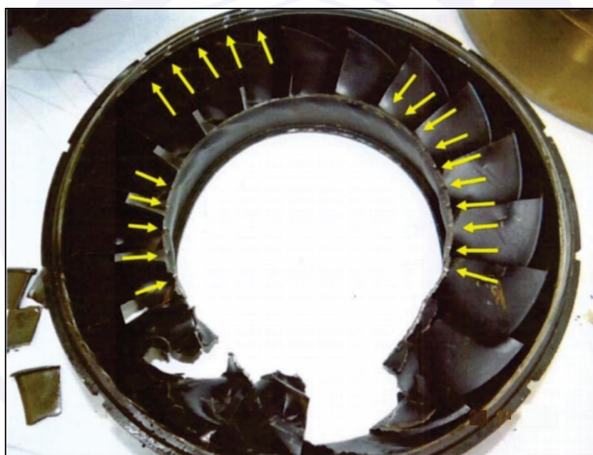
Figura 31 - Vista posterior do estator da turbina de potência do motor esquerdo com marcas de impacto parado e com dano nas aletas.
